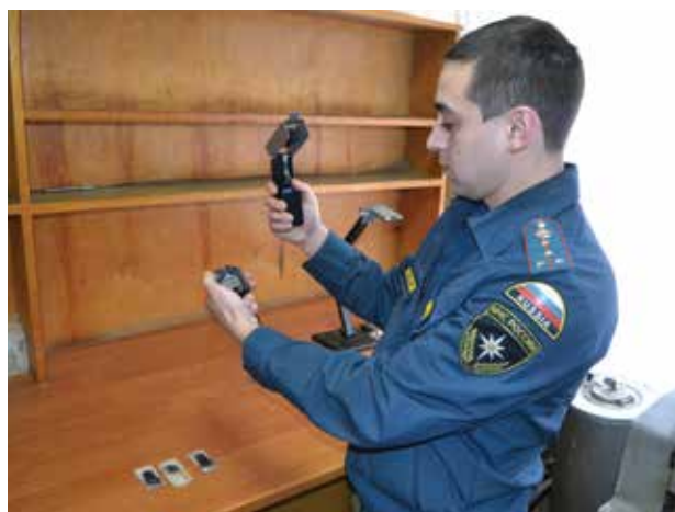
Испытания качества огнезащитной обработки деревянных конструкций на приборе ПМП-01
