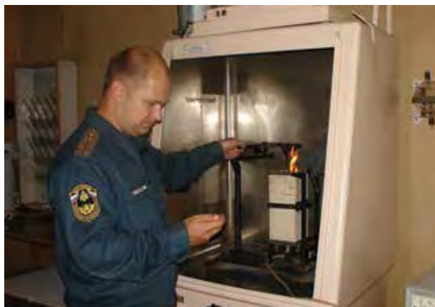
Работа на установке «Керамическая труба»
