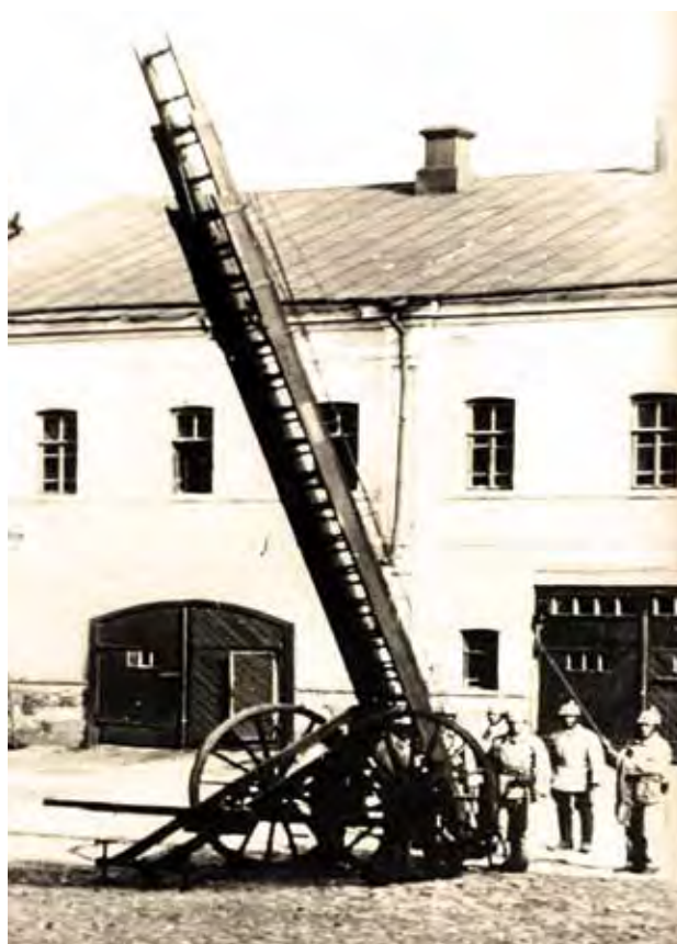
Пожарные городской пожарной команды Тулы демонстрируют работу трехколенной механической лестницы образца 1895 года
