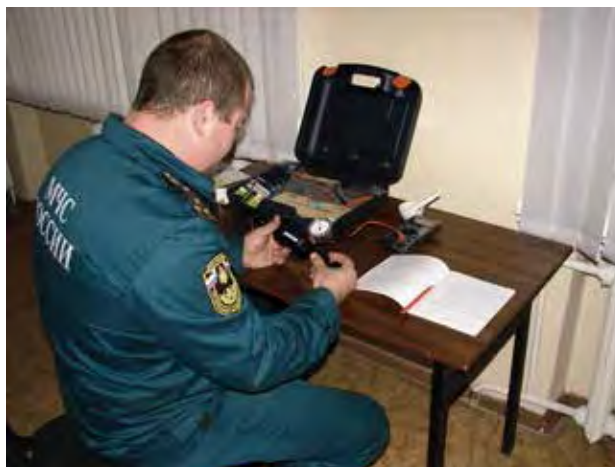
Комплект для измерения электросопротивления углей «Пресс»
