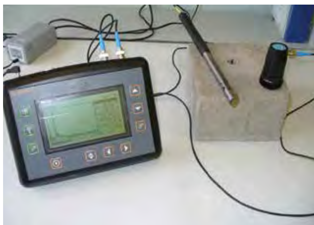
Прибор ультразвукового зондирования для исследования железобетонных конструкций УЗ 01-ЭП
