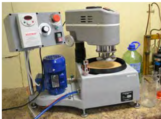
Прибор подготовки шлифов для металлографического исследования
