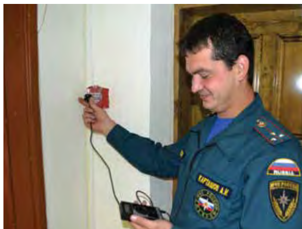
Замер освещенности люксметром
